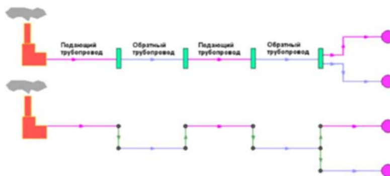
Рисунок 22 - Однолинейное изображение (вверху) и внутреннее представление (внизу) сети для летнего режима работы открытых систем централизованного теплоснабжения
